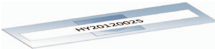
Der Objektträger des Gebrauchsnormals besteht aus Glas
